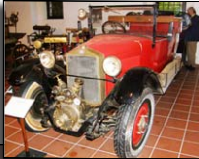
„Löschautomobil“ mit Vorbau-pumpe und seitlich angeordneten Schlauchhaspeln. Feuerwehr Wien, Baujahr 1928, Hersteller Steyr mit Aufbau v. Knaust. Leistung 30 PS.
