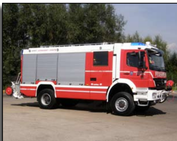
RLF-A 2600/400 der „FF Wels“ - für Österreich ein einzigartiges Modell - Heckbeladung mit 2 Aufprotzhaspeln
