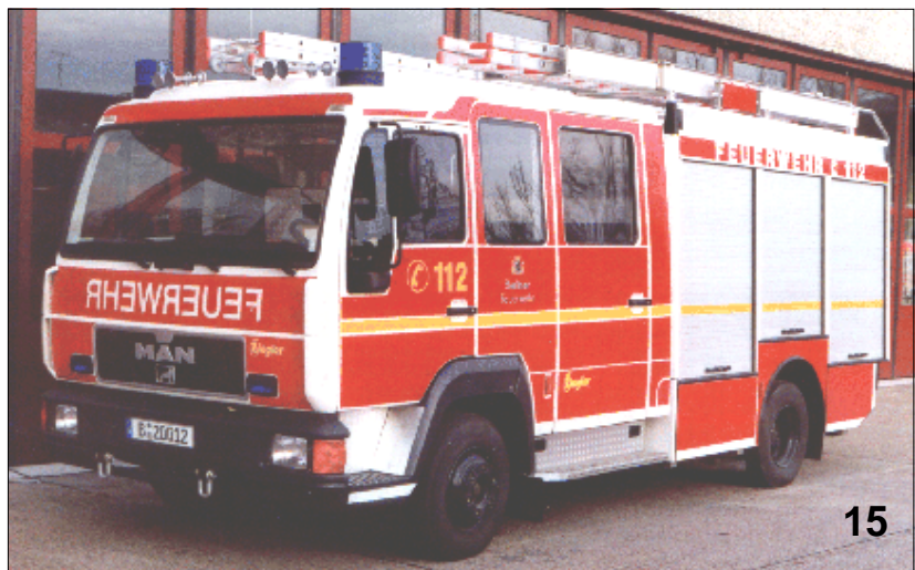
Ziegler LHF 16/12 mit ALPAS-Aufbau und integrierter Umfeldbeleuchtung.
