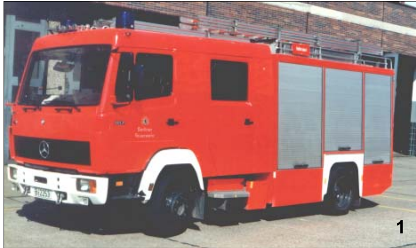
Prototyp 1: LHF 16/12 auf MB 1117 (Baureihe LN2), Aufbau u.Kabine: Rosenbauer
