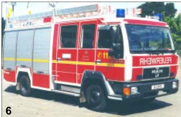
Erstes LHF 16/12 auf MAN mit Foliendesign, Aufbau Rosenbauer und die ab 1998 generell verwendete MAN-Wittlich-Kabine.
