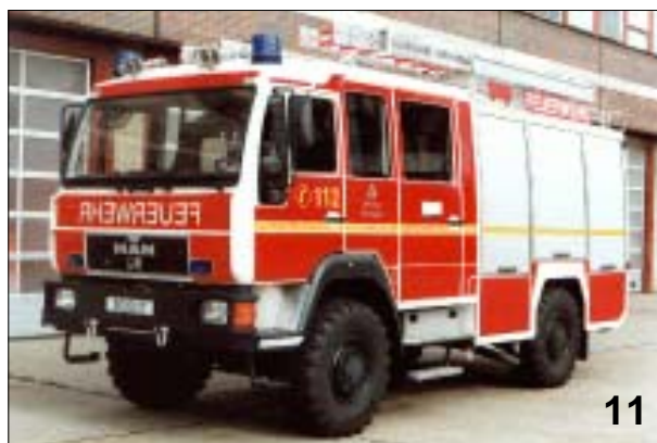
Das einzige LHF mit Allrad-Antrieb. Aufbau von Rosenbauer.
