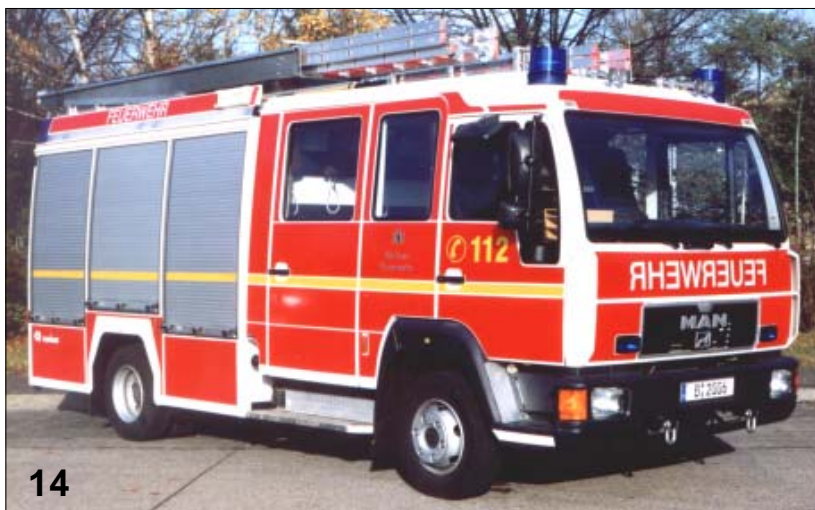
Einzelstück: Das Rosenbauer LHF 16/12 mit GFK-Aufbau und integrierter Umfeldbeleuchtung sowie elektropneumatischer Leiternaufgabe für die Schiebleiter.
