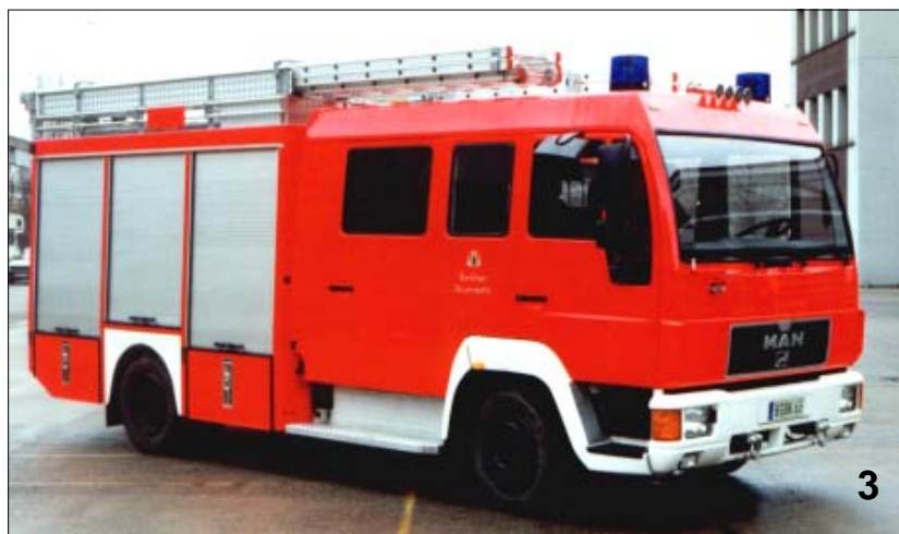
Prototyp 3: LHF 16/12 auf MAN 10.224 (Baureihe L2000), Aufbau u.Kabine: Ziegler
