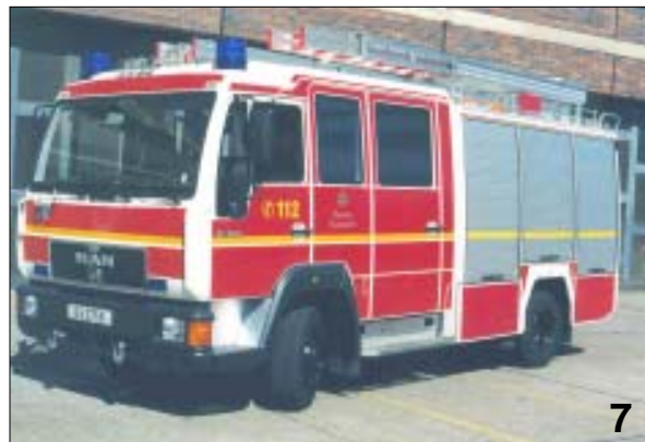
Erstes LHF 16/12 auf MAN mit Foliendesign, Aufbau Rosenbauer und die ab 1998 generell verwendete MAN-Wittlich-Kabine.
