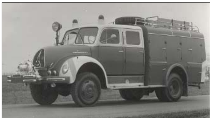
Der zweite Schlauchkraftwagen, der 1959 an die BF Wiesbaden geliefert worden ist. Warnanstrich, Blaulichter auf Fh-Dach, Reserverad auf Aufbau-Dach, Fahrerhaus in Ganzstahlbauweise. Werkfoto Magirus.
