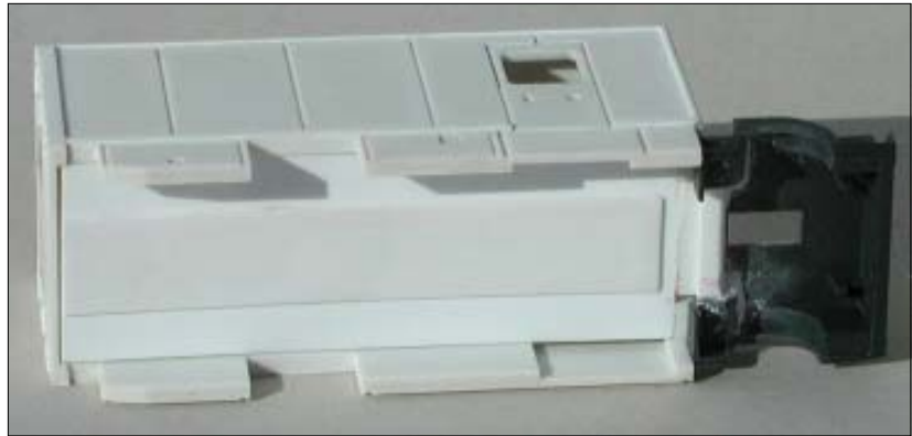
Der Boden passt. Auf der Innenseite befinden sich Absätze, die zum geraden Ausrichten der Bodenplatte erforderlich sind.
