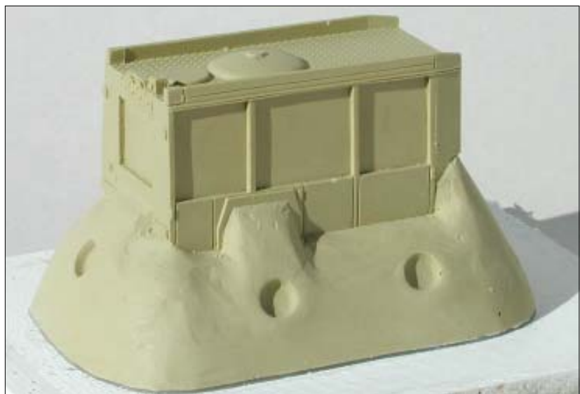
Oben: Matrice = Abformmodell des TroLF 2000 Flughafen Düsseldorf (Positiv). Unten: Matricensätze des LF 16 MB Kurzhauber, BF Frankfurt (Positiv und Negativ).
