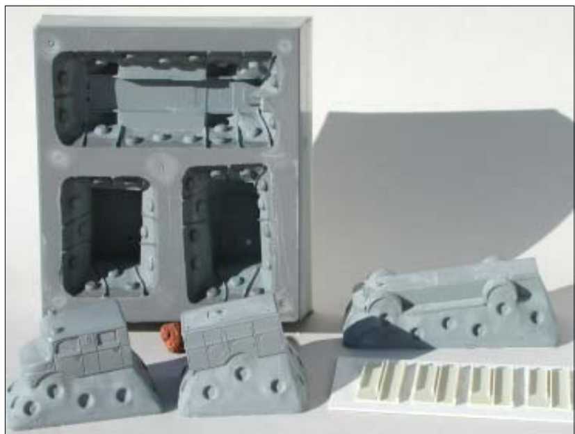
Oben: Matrice = Abformmodell des TroLF 2000 Flughafen Düsseldorf (Positiv). Unten: Matricensätze des LF 16 MB Kurzhauber, BF Frankfurt (Positiv und Negativ).
