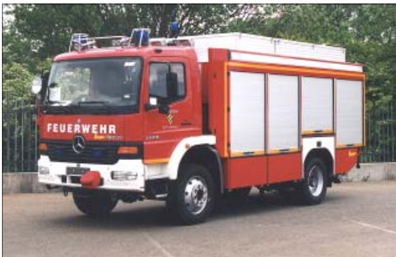
Unten: Sehr gefällig ist die Optik des neu gestalteten RW 2 auf einem MB-Atego vom Typ 1325 AF. Der Aufbau weist nun beidseitig jeweils vier Rollläden auf. Die Umfeldbeleuchtung reicht ohne Unterbrechung über die gesamte Aufbauhöhe.
